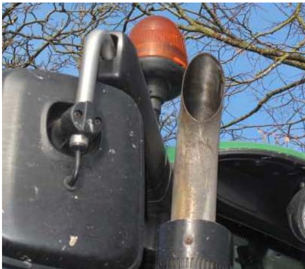
Abbildung 1: Russfreies Auspuffrohr nach 1600 Betriebsstunden mit Partikelfilter.
