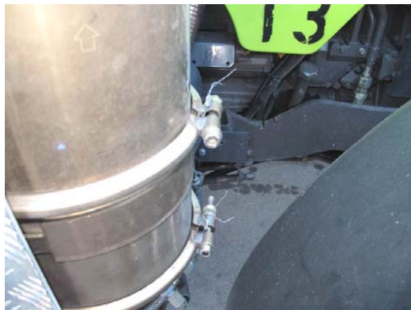
Abbildung 5: Alle Filter waren während des Projekts mit Plomben versehen.
