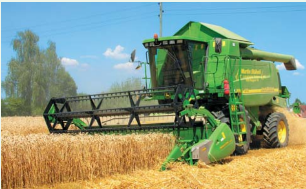
Der Mähdrescher ist so einzustellen, dass viele Strohanteile, Spelzen und Schmachtkörner ausgeschieden werden.
